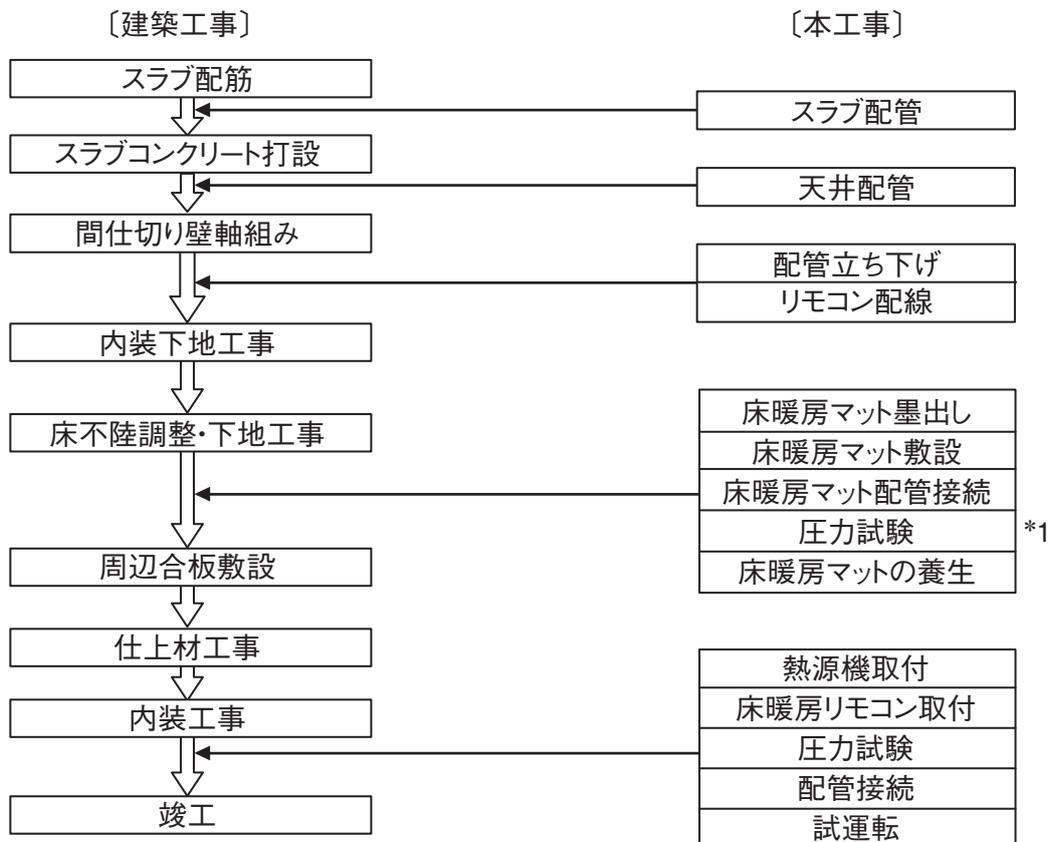
\* 1 床仕上げ工事終了まで圧力試験の圧力を保持する。
